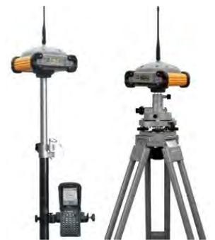
Exemples d'antenne et de capteur DGPS (sur canne et trepied)
