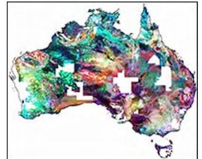
Exemple de carte de levé radiométrique des rayons gamma naturels à l'échelle de l'Australie (Potassium en rouge, Thorium en vert et Uranium en bleu)
