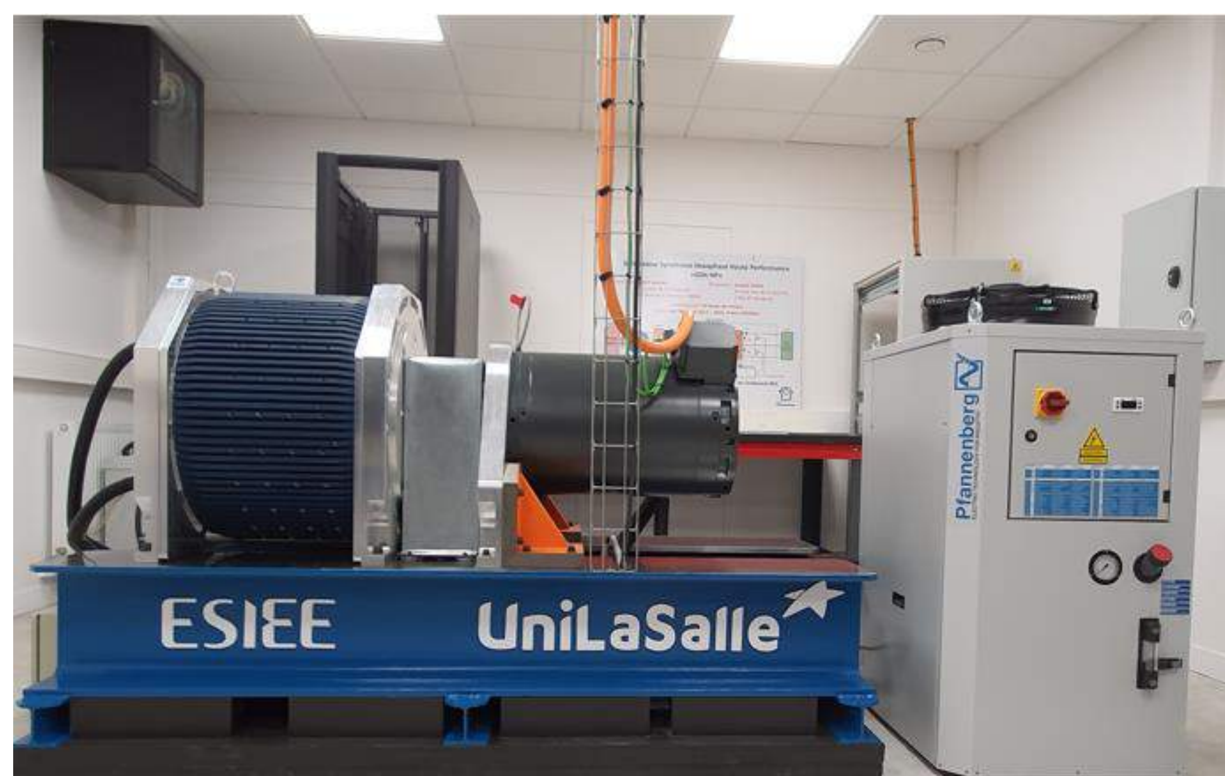
Figure 4: Vue d'ensemble du micro-réseau SYMADE équipé du générateur GS2HP (à gauche) couplé au moteur couple (Turbine) à droite. Le refroidisseur (à droite) alimente la turbine.
